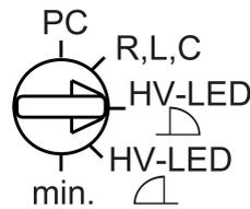
Imagen 4: Conmutador de modos de funcionamiento
