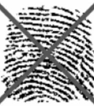
Snímač potom snímá jen otisk prstu jen v horní oblasti plošky prstu, to znamená příliš daleko nad středem zakřivení otisku prstu. Tam je podstatně méně zakřivených papilárních linií, a proto někdy systém může zjistit příliš málo signifikantních charakteristik.
