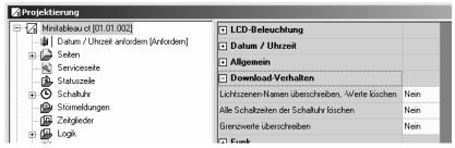
Bei der ersten Inbetriebnahme eines Gerätes mit neuen Projektierungsdaten müssen diese Teile einmalig überschrieben werden. Hierfür sind vor dem Download die oben dargestellten Parameter auf "Ja" zu stellen. Nach dem erstmaligen Download können die Parameter wieder auf "Nein" zurückgestellt werden, um gegebenenfalls vom Anwender vorgenommene Änderungen nicht zu löschen.
