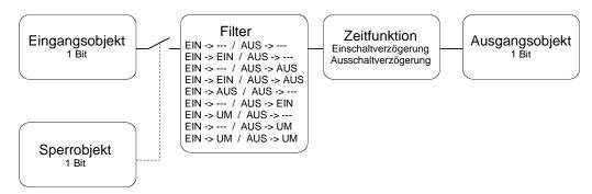
Das Sperrobjekt ist ein 1-Bit-Kommunikationsobjekt, wobei das Verhalten (Sperre bei 0, Sperre bei 1) einstellbar ist. Wenn während einer Sperre der Wert des Eingangs geändert wird, kann der Ausgang automatisch ein Telegramm senden, sobald die Sperre aufgehoben wird, oder er wartet bis zum nächsten Eingangstelegramm.
