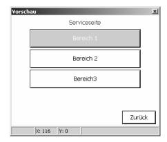
Um die Serviceseite öffnen zu können, muss auf einer anderen Seite ein Anzeigeelement angelegt sein, bei dem eine Taste über die Funktion "Seitenaufruf" einen Sprung zur Serviceseite ausführt.
