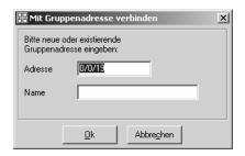
Die Verwendung interner Gruppenadressen ist sinnvoll, wenn zum Beispiel der Ausgang einer Schaltuhr nur mit dem Steuereingang eines Multiplexers verbunden werden soll.
