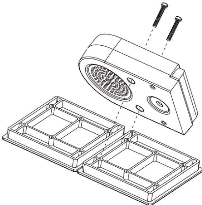
Para la fijación del altavoz empotable deberá utilizar exclusivamente los tornillos adjuntos.
