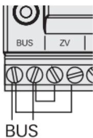
1. Conecte el bus de 2 conductores a los bornes BUS.
