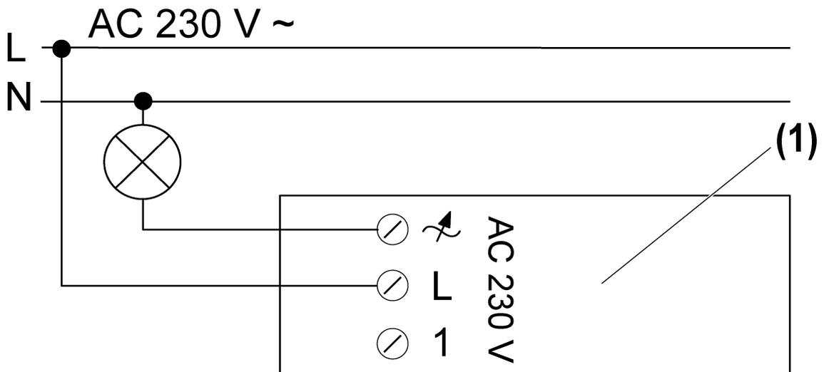
Imagen 3: Plano de conexión del regulador de luz
