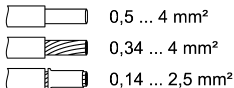
rysunek 8: Przekrój przewodów odpowiedni do zacisków
