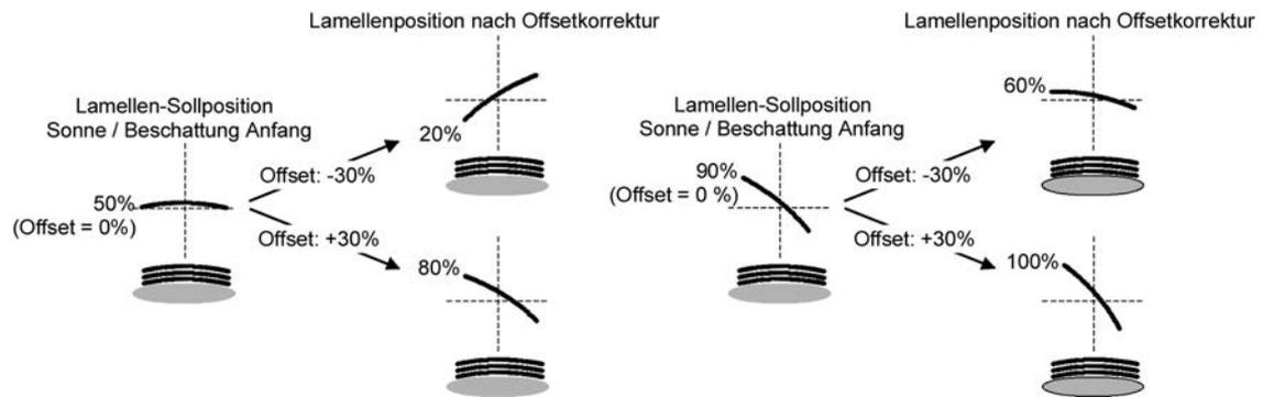
Bild 39: Funktionsweise des Lamellenoffsets als Beispiel
