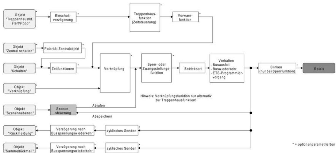
Bild 23: Funktionsschaltbild der Szenenfunktion
