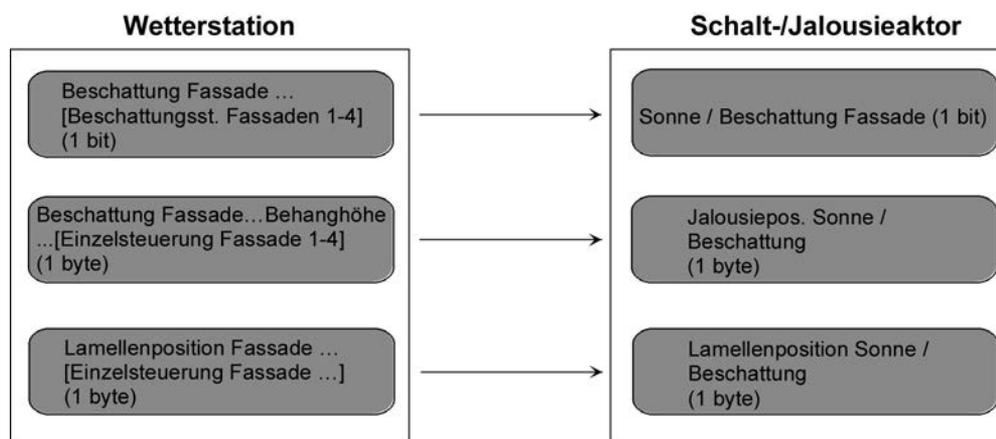
Bild 43: Projektierung der Kommunikationsobjekte für Anwendungsbeispiel IV.
