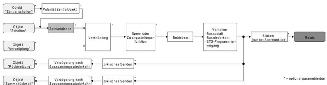
Bild 18: Funktionsschaltbild der Zeitverzögerungen
