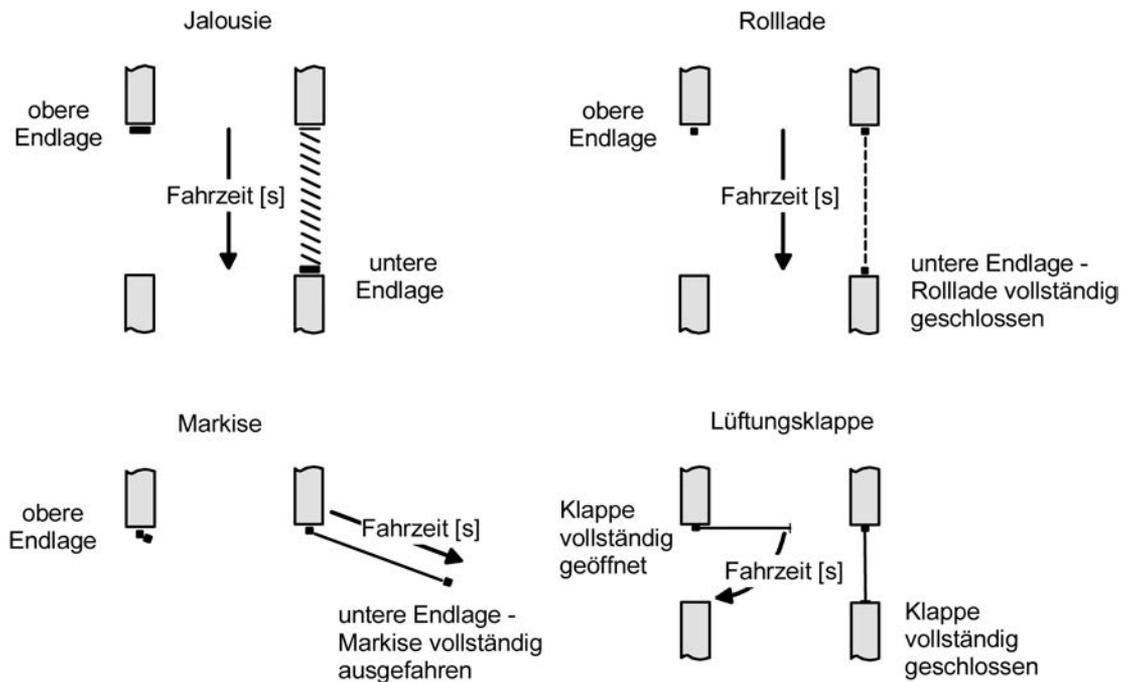
Bild 28: Ermittlung der Fahrzeit in Abhängigkeit der Antriebsart
