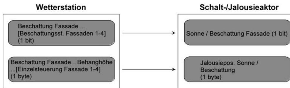
Bild 44: Projektierung der Kommunikationsobjekte für Anwendungsbeispiel V.
