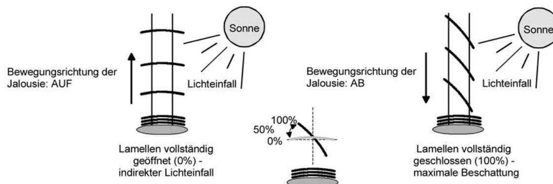
Bild 30: Typ 2 - Lamellenjalousien mit schräger und gerader Lamellenstellung
