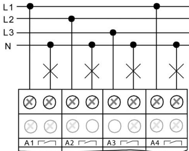
Bild 6: Elektrischer Anschluss für Lasten im Schaltbetrieb
