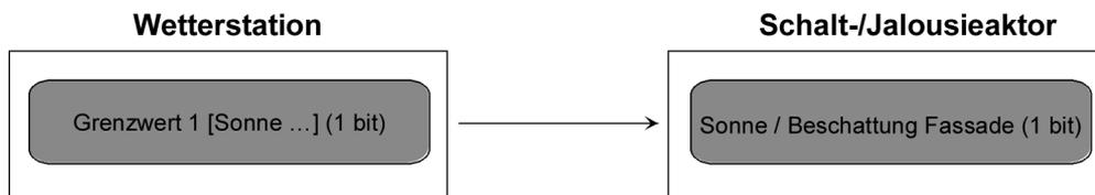
Bild 40: Projektierung der Kommunikationsobjekte für Anwendungsbeispiel I.
