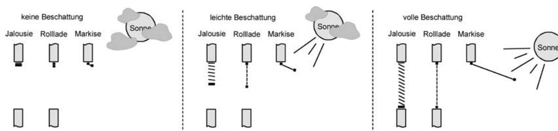
Bild 36: Prinzip eines Sonnenschutzes (Beispiele)
