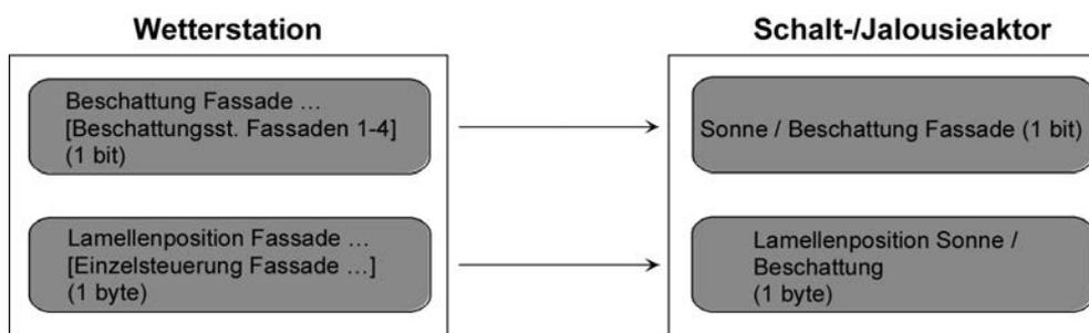
Bild 42: Projektierung der Kommunikationsobjekte für Anwendungsbeispiel III.
