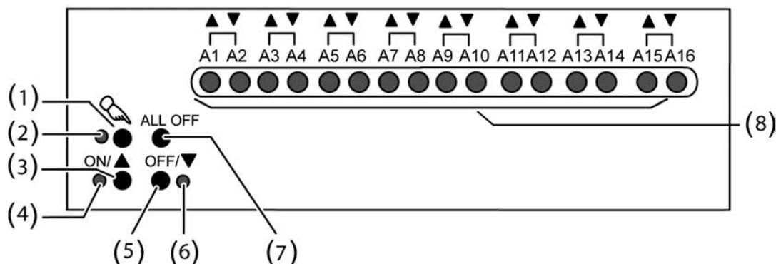
Bild 11: Bedien- und Anzeigeelemente der Handbedienung beim Schalt-/Jalousieaktor 8/16fach
